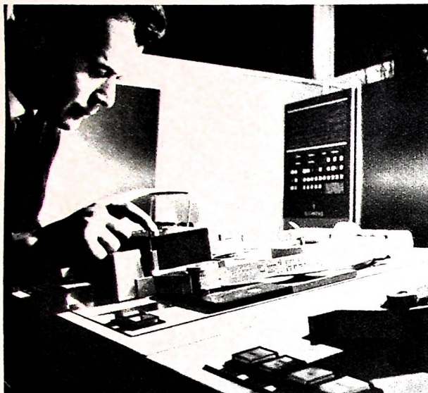
Die Siemens-Datenverarbeitungsanlage „3003“ als Satzrechner; links: die Geräte für die Eingabe des Endlos-Lochstreifens und für die Ausgabe des setzreifen Lochstreifens; rechts: die Zentraleinheit der Datenverarbeitungsanlage und der Blattschreiber, mit dem der Operator seine Anweisungen an den Rechner durchgeben kann
